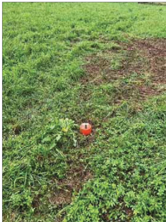
Misura del microtremore sismico mediante tecnica H.V.S.R.
