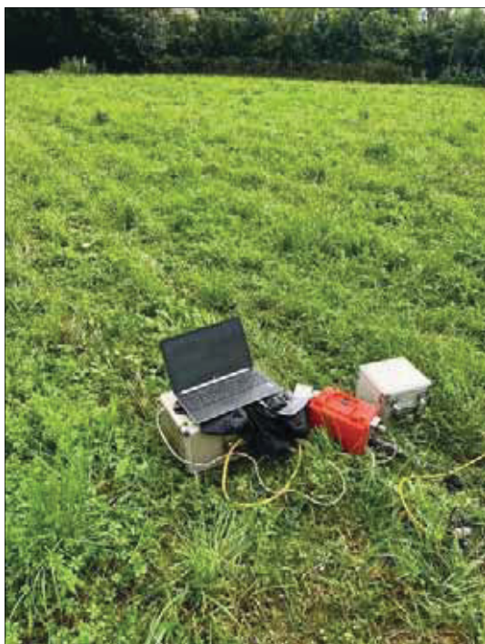
Acquisizione del segnale sismico mediante Sismografo Geometrics
